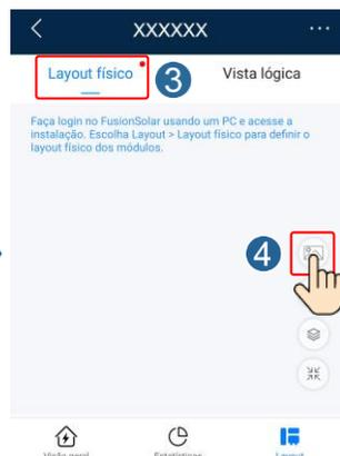
2. Faça login em <https://intl.fusionsolar.huawei.com> para acessar a WebUI do sistema de gerenciamento FusionSolar Smart PV. Na **Página inicial**, clique no nome da instalação para ir para a página da instalação. Selecione **Layout**. Escolha **Gerar layout**, e crie um layout físico, conforme solicitado. Você também pode criar manualmente um layout de local físico.
